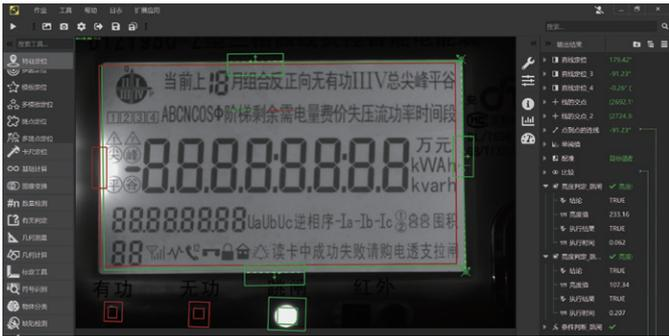
**Anforderung:** Fehlende Zeichenerkennung auf dem LCD-Bildschirm, Prüfung der Anzeige der Leistungs-LED.
